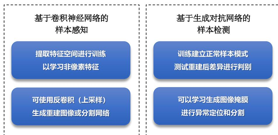
图 3-1 基于卷积神经网络与生成对抗网络的工业异常检测相关关键技术
